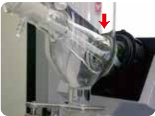
專利防冷凝液回流設計 (專利號7209346)
